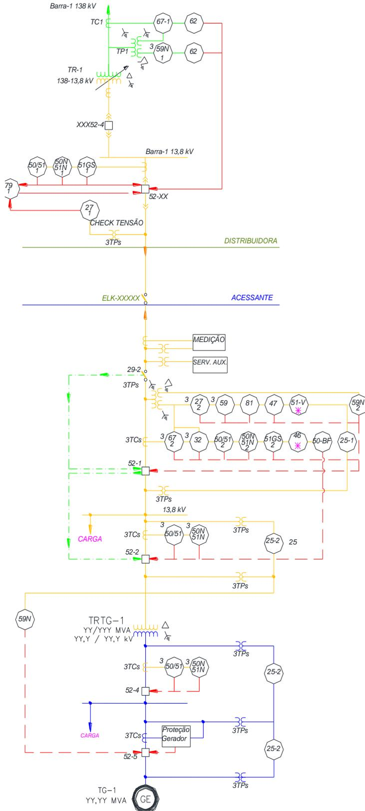
CÓDIGO NUMÉRICO DAS FUNÇÕES DOS DISPOSITIVOS DE MANOBRA, CONTROLE E PROTEÇÃO DO SISTEMA CONFORME IEEE Std C37.2-1996 e INBR 5175-MAIO/1998!
