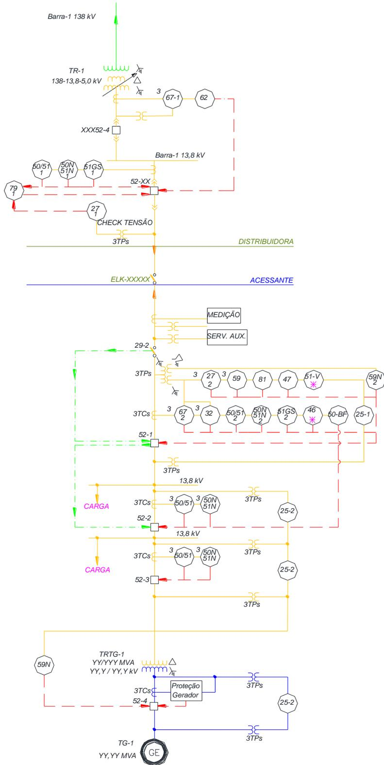
CÓDIGO NUMÉRICO DAS FUNÇÕES DOS DISPOSITIVOS DE MANOBRA, CONTROLE E PROTEÇÃO DO SISTEMA CONFORME IEEE Std C37.2-1996 e INBR 5175-MAIO/1998!
