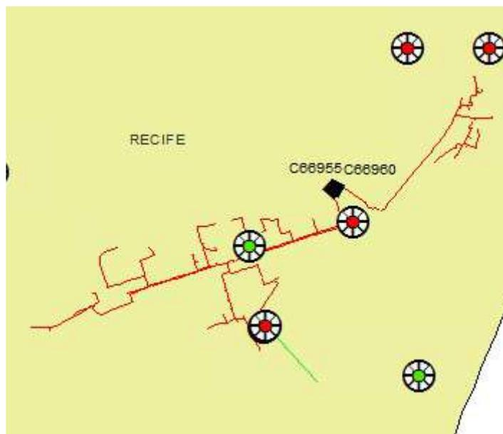
Figura 44 – Todos alimentadores do conjunto Gazômetro que sofreram interrupções.
