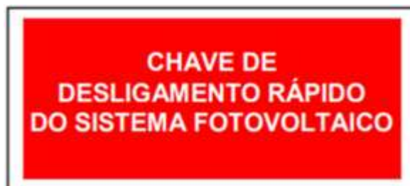
Figura 2 - Sinalização do interruptor para desligamento rápido - ABNT NBR 17.193:2025
