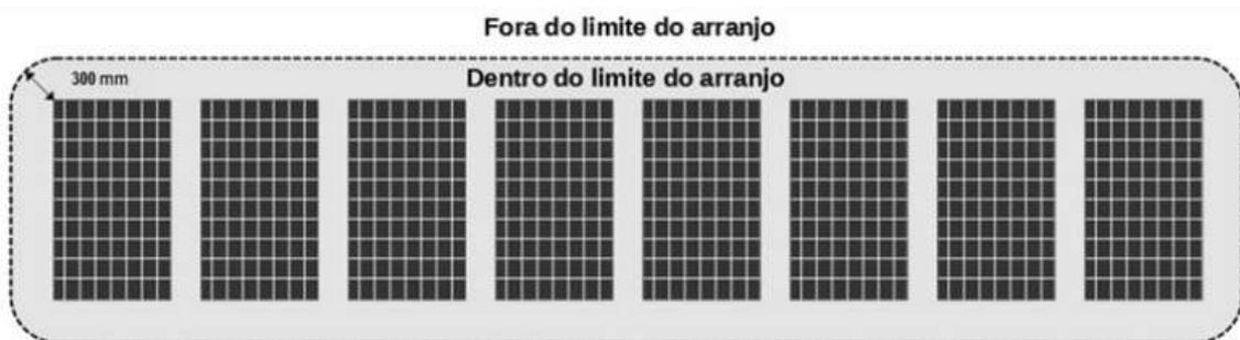
Figura 1 - Representação dos limites de um arranjo fotovoltaico - ABNT NBR 17.103:2025
