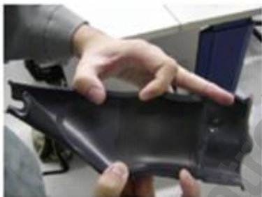
Figura 09b – Detalhe da superfície semicondutora de uma terminação de borracha de silicone
