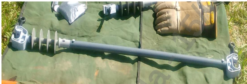
Figura 06 – Espaçador Pronto para ser instalado
