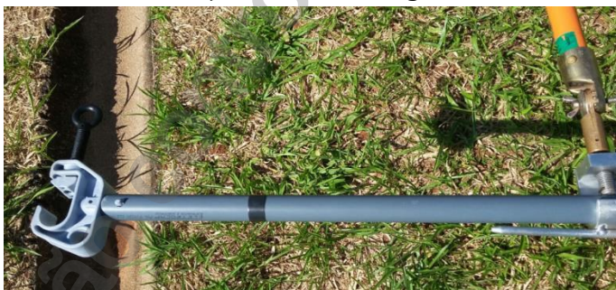
Figura 03- Engate do bastão no espaçador
