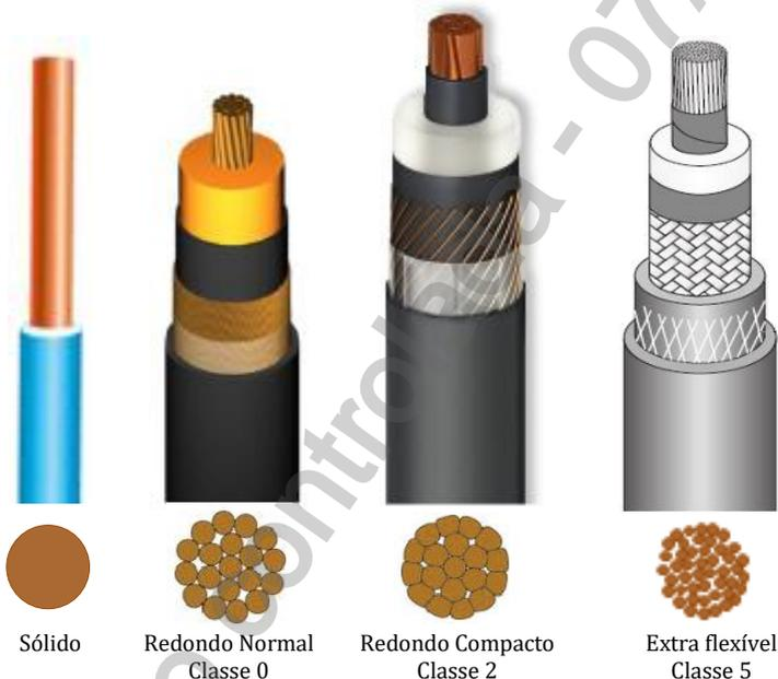
Figura 02 - Ilustrações com classes de encordoamento
