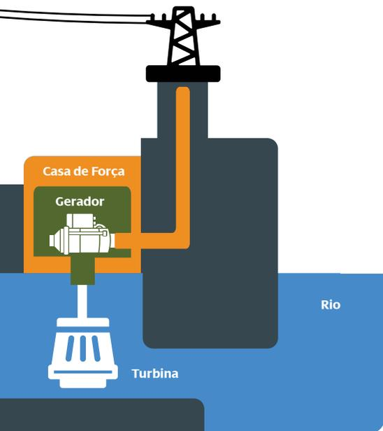
A **UHE Itapebi** é do tipo a fio d'água, isso significa que ela não possui capacidade para armazenar água, e toda água do reservatório passa pelas turbinas para geração de energia ou é vertida.
