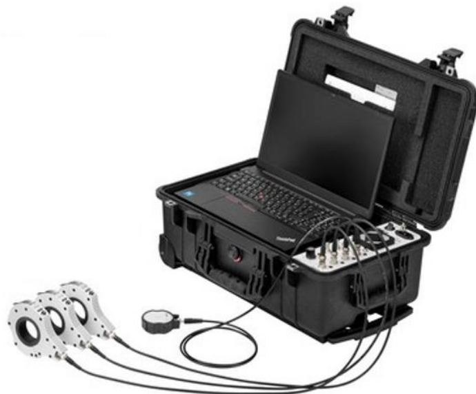
1 - Equipamento para medição de Descargas Parciais online
