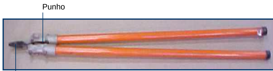
Alicate sem isolamento no cabo
