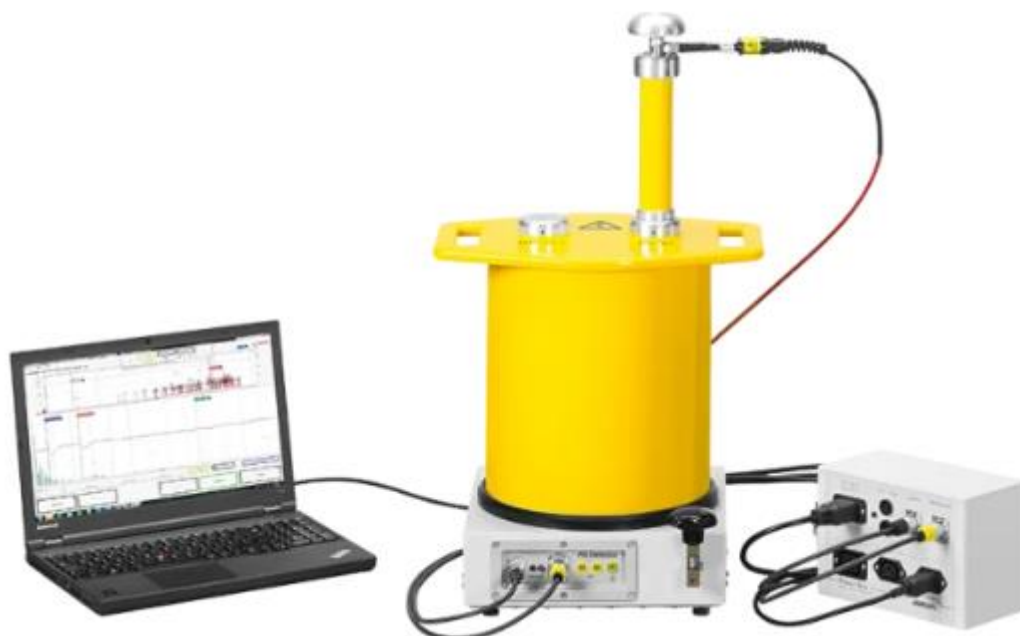
4 - Equipamento para medição de Descargas Parciais offline
