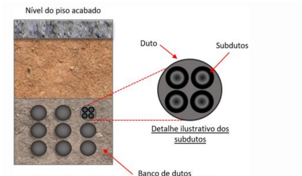
Figura 7 - Compartilhamento de dutos subterrâneos para redes de telecomunicações- Instalação de subdutos
