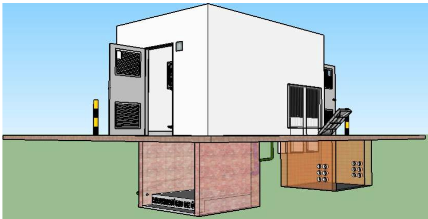
Figura 45 - Estação Transformadora para 1 transformador de até 225 kVA (9/9)
