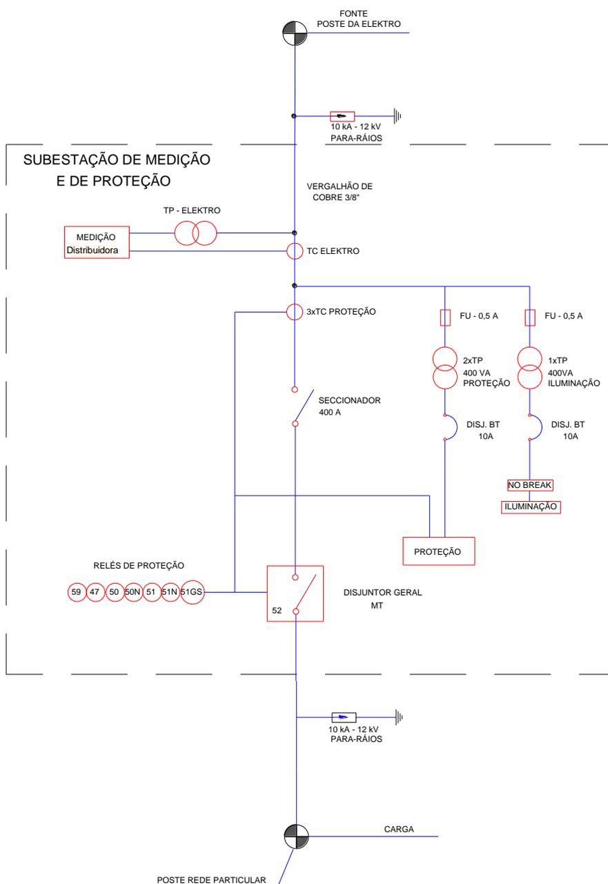
Diagrama Trifilar de Proteção
