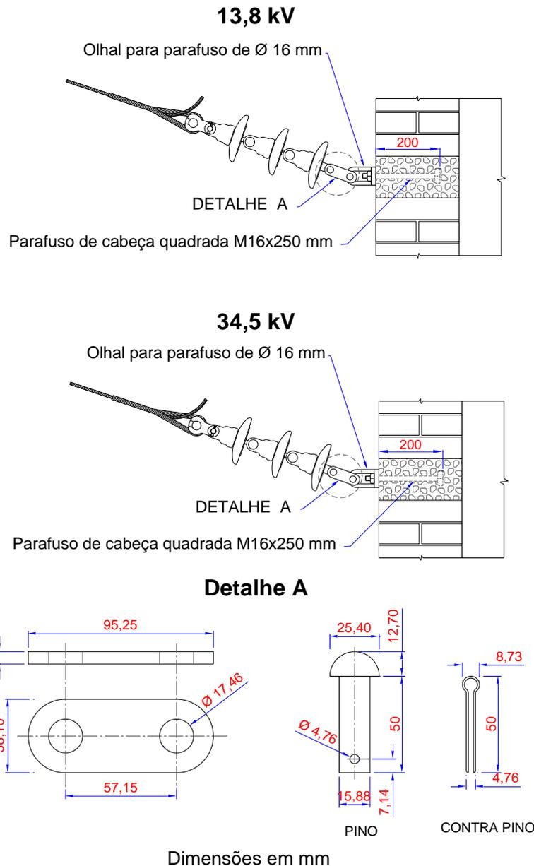
Nota: Os parafusos para fixação da cadeia de isoladores devem ser colocados por ocasião da concretagem da laje.
