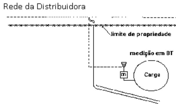
**Figura 11 – Ramal em MT com Medição em Média Tensão em Propriedade Rural**
