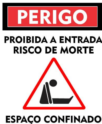
Figura 5 - Sinalização de espaço confinado
