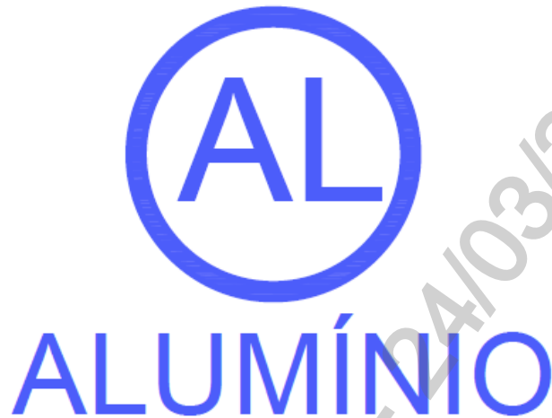
Figura 5 – Identificação do material do enrolamento de alumínio
