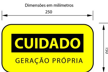
Modelo de placa de identificação que deve ser instalada na Unidade Geradora.
