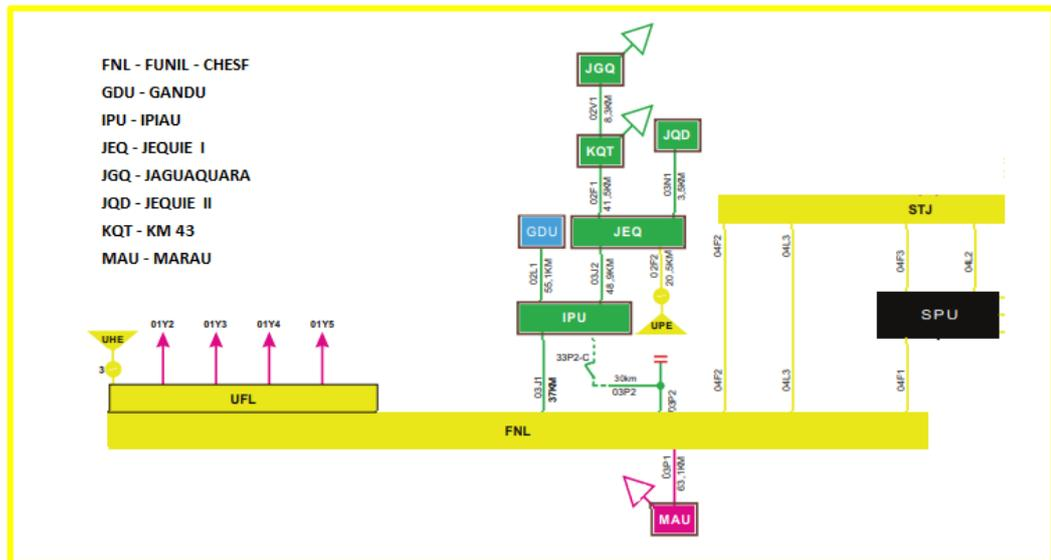
Figura 5 - Diagrama Unifilar Subtransmissão Funil - CHESF (FNL)
