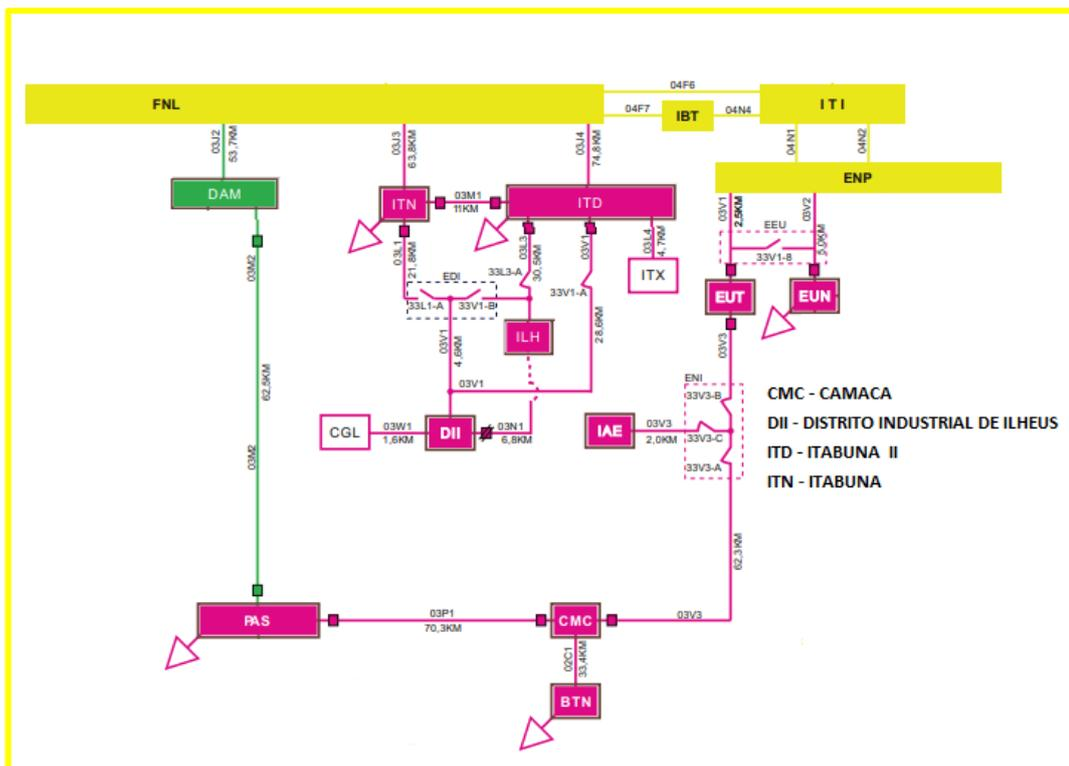
Figura 8 - Diagrama Unifilar Subtransmissão Funil CHESF (FNL) – Região Sul
