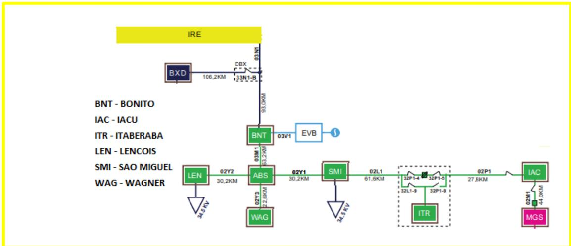
Figura 7 - Diagrama Unifilar Subtransmissão Irecê - CHESF (IRC)
