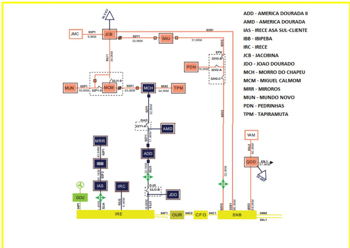
Figura 4 - Diagrama Unifilar Subtransmissão Irecê – CHESF (IRC) e Senhor do Bonfim – CHESF (SNB)
