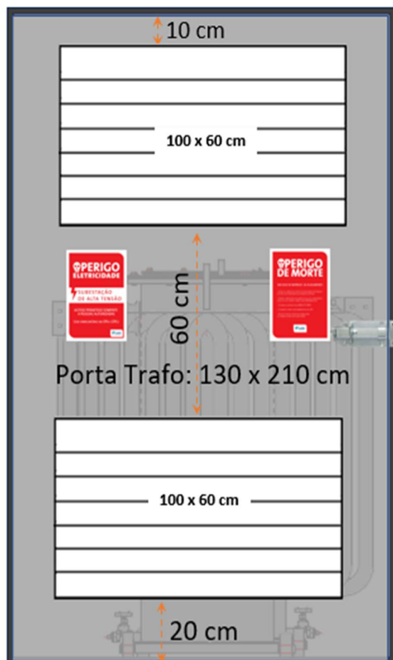
Porta Trafo: CT 15 kV
