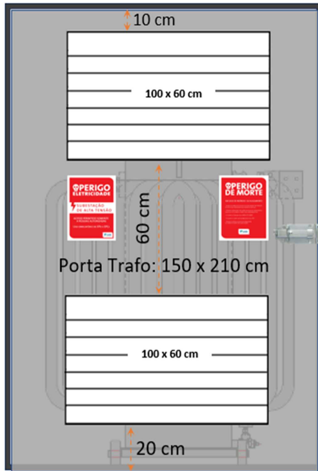
Porta Trafo: CT 34,5 kV
